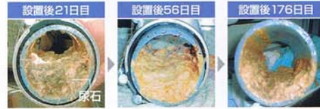
[尿石除去実験] (都内某ビルのデータ)
