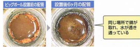
[尿石除去実験] (都内某ビルのデータ)
